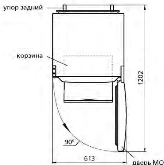
Рисунок 2 – Холодильник (вид сверху)
