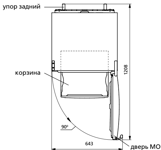
Рисунок 2 – Холодильник (вид сверху)
